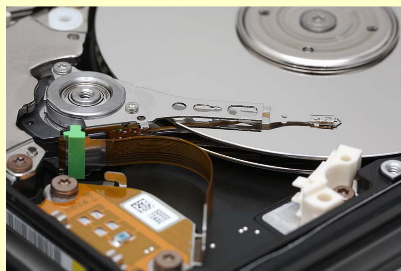
Moderne Festplatten nutzen GMR (Foto: http://commons.wikimedia.org/wiki/User:Mfield , Creative Commons Attribution ShareAlike 3.0)
